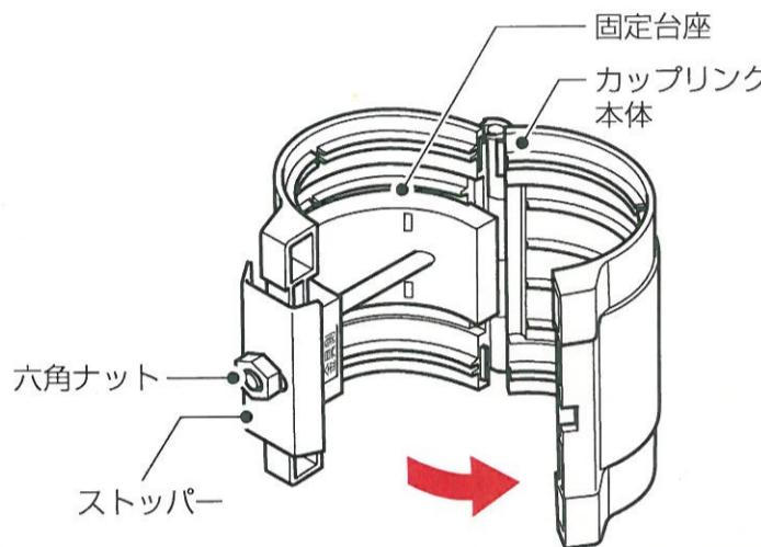
①カップリングの六角ナットをゆるめ、ストッパーをずらし、カップリング本体を開けます。
