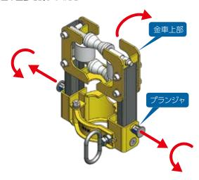
3 プッシュノブを押し上げて上部ローラを開き、ローラ間へ 電線を挿入したらプッシュノブを押し下げて上部ローラを 閉じてください
