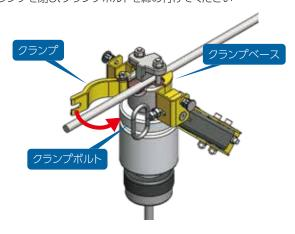
4 クランプがいしの電線押え蓋を開き、プランジャを引き ながら回し、引いた状態を保持して金車上部を引き上げ 直立させてください
